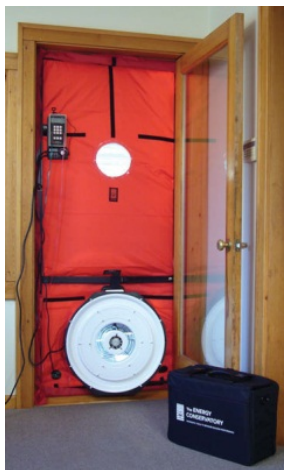
Uitvoeren van een blowerdoortest
